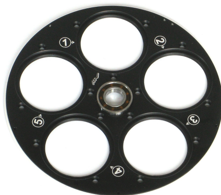
Obr. 19: Číslo pozic filtrů jsou vyznačena na kole
